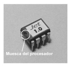
Una vez insertado el chip, esta marca debe estar en la parte del zócalo mas próxima al logo de Franspeed, tal y como se puede apreciar en la siguiente fotografía.
