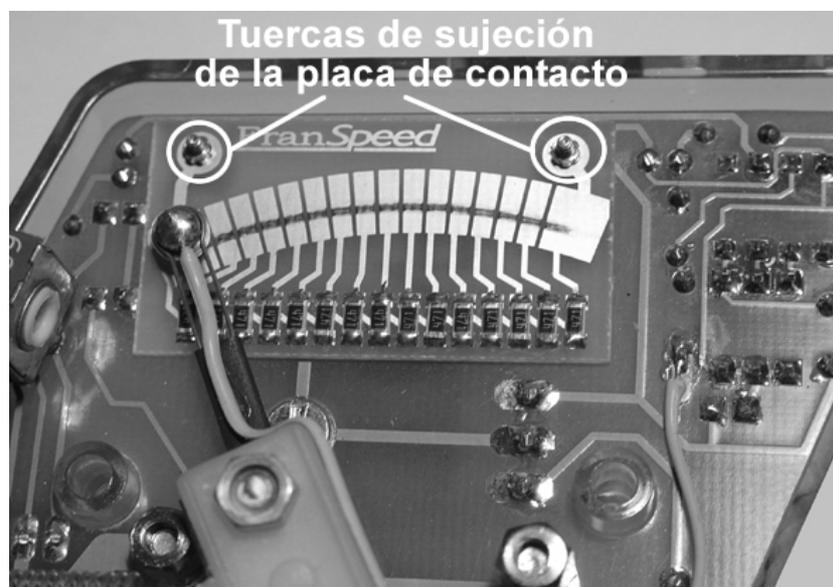
Si viéramos que la placa de contacto esta dañada, procederíamos a su substitución por una nueva de la siguiente forma:
